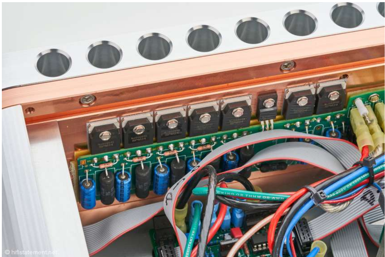
Die bipolaren Endstufen-Transistoren sind auf die Kupferplatten geschraubt. Hier die NPN-Typen des linken Kanals
